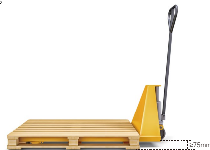
液压叉车周转叉齿高度要求示意图
