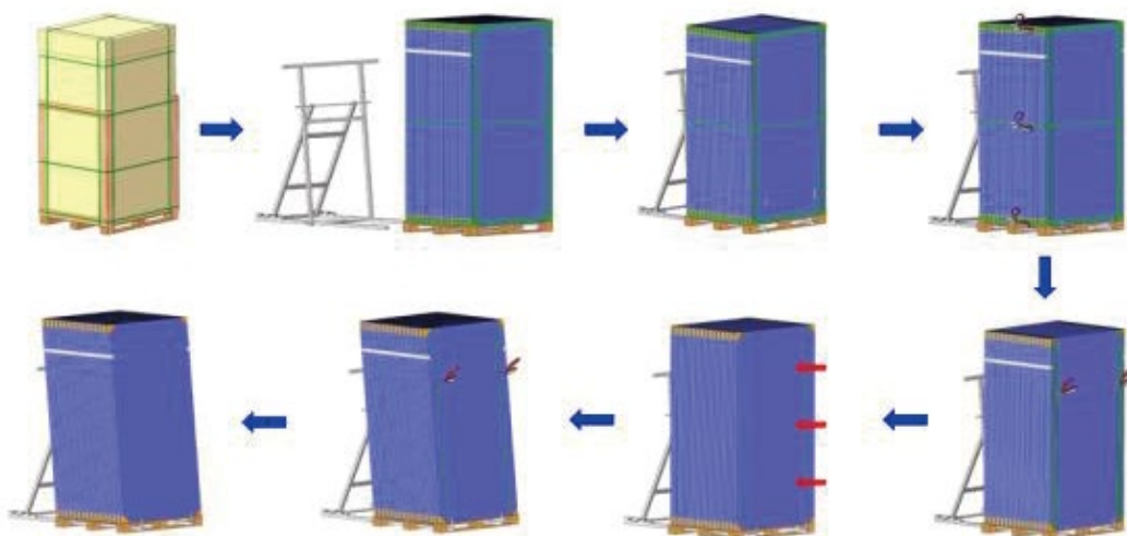
长边立式拆包步骤
