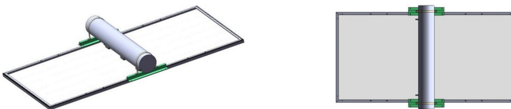
图 3 单轴跟踪系统组件安装示意图
